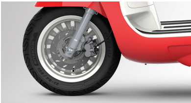
Sistem Pengereman ABS Mencegah roda terkunci saat pengereman, menjaga stabilitas, membuat perjalanan lebih aman.
